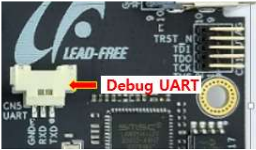
10-pin JTAG header (angle type 0.05")
